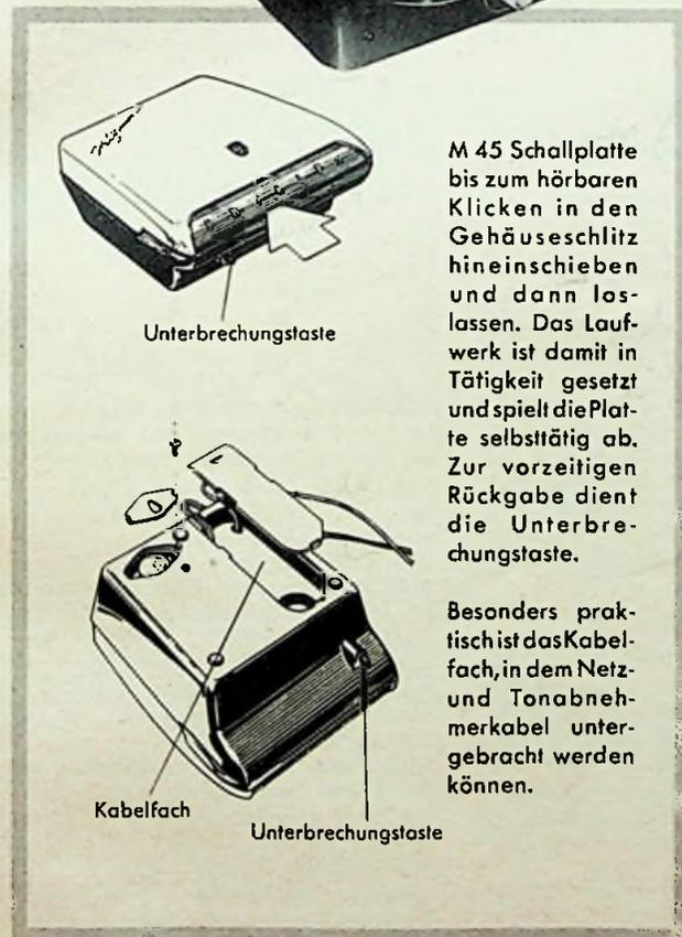
M 45 Schallplatte bis zum hörbaren Klicken in den Gehäuseschlitz hineinschieben und dann loslassen. Das Laufwerk ist damit in Tätigkeit gesetzt und spielt die Platte selbsttätig ab. Zur vorzeitigen Rückgabe dient die Unterbrechungstaste.
